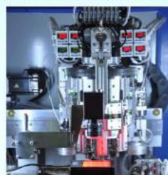
高速十二轴运动控制系统 High-speed twelve axis motion control system
