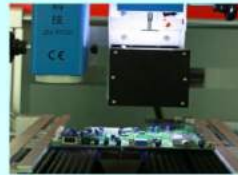
光学对位装置 Optical alignment system
